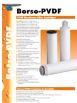
Borso-PVDF PVDF membraanfilter- kaarsen. 0.2 micron voor ont- en beluchting.
