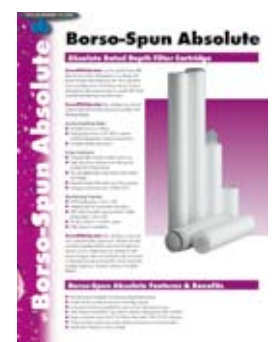
Borso-Spun Absoluut Polypropyleen, Nylon en PPS (ryton) meltblown. Beta 5000 (99,98%).
